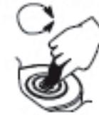
2. Tropfen Sie mit Plastikpipetten die Probe auf die Prismaoberfläche. Füllen Sie die Wanne vollständig.
