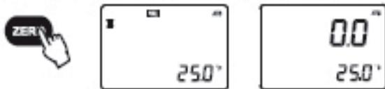
4. Nehmen Sie vorsichtig den Zero Wasserstandard mit einem weichen Tuch auf. Achten Sie darauf, die Prismaoberfläche nicht zu verkratzen. Wischen Sie die Oberfläche vollständig ab. Das Gerät ist für die Probenmessung bereit.
